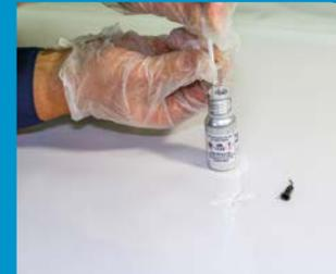
**Schritt 3:** Ziehen Sie den Inhalt mit der Spritze aus der Flasche.
