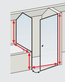
Verkürzte Seitenwand mit Schrägschnitt
