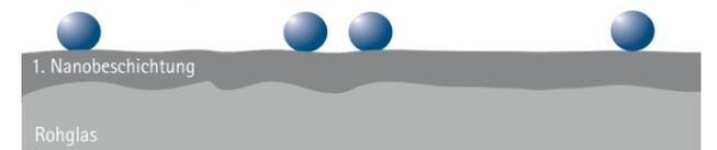
Das Glas wurde mit einer Nanobeschichtung versehen, von welcher Kalk- und Schmutzpartikel einfacher abperlen.
