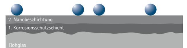
Das geglättete und zugleich mit einer Nanobeschichtung versehene Glas bietet kaum Angriffsfläche für Kalk- und Schmutzpartikel.
